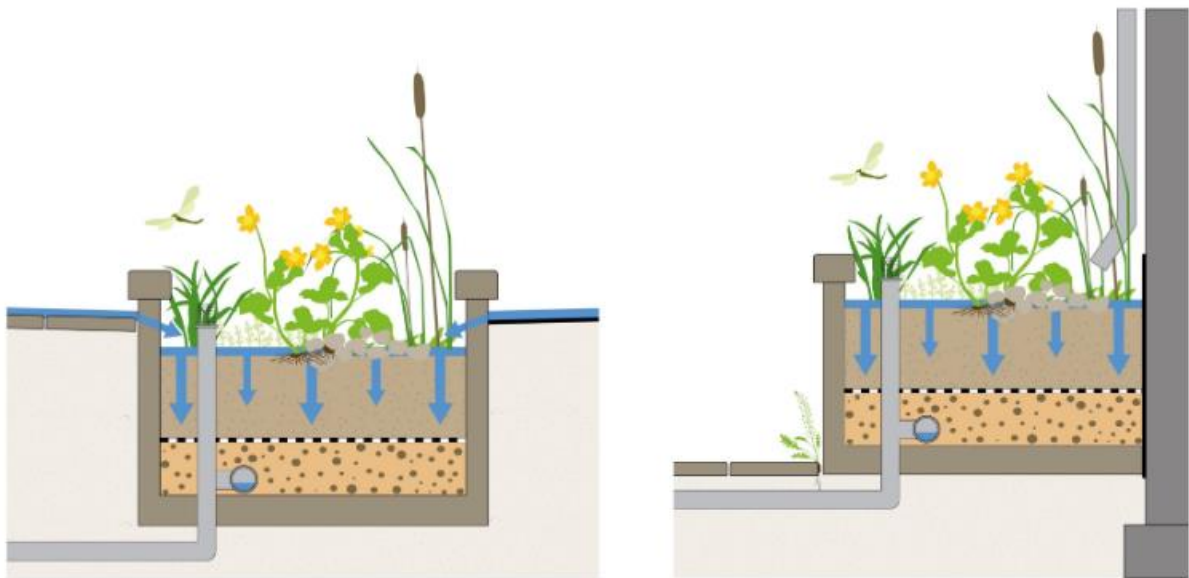
Schematische doorsneden van watervasthoudende plantenbakken. ©Atelier GROENBLAUW.
